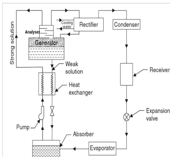
Figure 2.D:- Vapour Absorption Cycle
